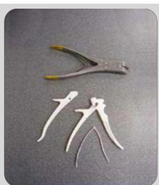
由 Objet30 桌上型 3D 打印机打印的 Orchid 医疗设备和假体原型
