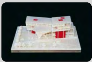
在 Objet 3D 打印机上打印的 Rietveld 建筑原型
