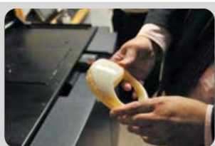
在 Stratasys 3D 打印机上打印的 Iviv 医疗设备原型
